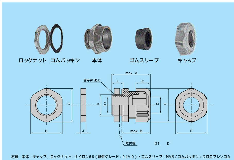
材質 本体、キャップ、ロックナット：ナイロン66 (難燃グレード：94V-0) / ゴムスリーブ：NVR / ゴムパッキン：クロロブレンゴム
